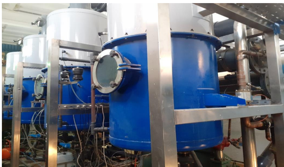
Рисунок 8 – Вакуумный выпариватель Шелл Евразия Экоприма 50 000 CR
